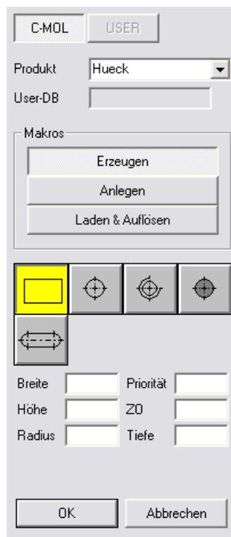
Zunächst sind die einzelnen Grundmakros auf der Zeichenfläche zu erzeugen, wobei auch bereits Bearbeitungstiefen (ZO, Tiefe) und eine Bearbeitungspriorität zugewiesen werden kann. Für das exakte Positionieren der Grund-Makros zueinander können die normalen CAD-Kommandos (z.B. „Selektieren“, „Verschieben“, ...) verwendet werden. Aus den Grundmakros entsteht dann ein zusammengesetztes Makro, z.B.:
