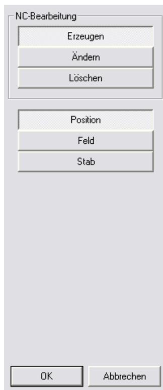
Auf der Zeichenfläche ist nun eine Position zu selektieren, welcher die Standard-NC-Bearbeitungen zugewiesen werden sollen. Das anschließende <ENTER> erzeugt nun die NC-Bearbeitungen und stellt sie an der Position dar.
